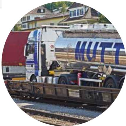
**Le ferroutage** est le fait de charger un camion entier sur un train. Il est aujourd'hui principalement utilisé pour le passage de montagnes ou de bras de mer (tunnel sous la Manche).
