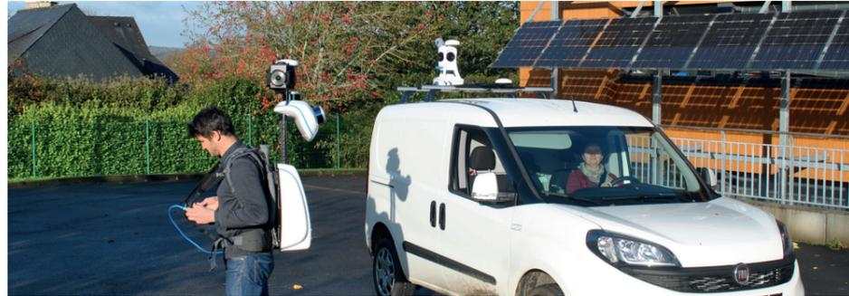
Le SDEF réalise l'acquisition en cartographie mobile de près de 20 000 km de voirie. Le nuage de points ainsi relevé permet de représenter l'ensemble du corps de rue en trois dimensions avec une précision inférieure à 5 cm.
