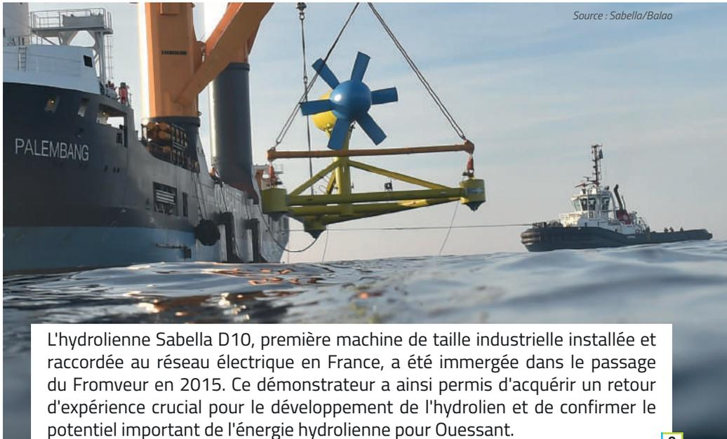
L'hydrolienne Sabella D10, première machine de taille industrielle installée et raccordée au réseau électrique en France, a été immergée dans le passage du Fromveur en 2015. Ce démonstrateur a ainsi permis d'acquérir un retour d'expérience crucial pour le développement de l'hydrolien et de confirmer le potentiel important de l'énergie hydrolienne pour Ouessant.
